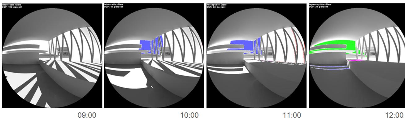
Análisis de deslumbramiento en el gimnasio cubierto
